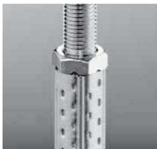
El grupo de regulación (dado + tornillo M16, excursión micrométrica 15-120 mm según la altura del tornillo) está dotado de un sistema anti-atornillado gracias a las incisiones efectuadas sobre el dado en soporte del tubo de la base, evitando variaciones en la regulación después de posibles variaciones en la colocación completa.
